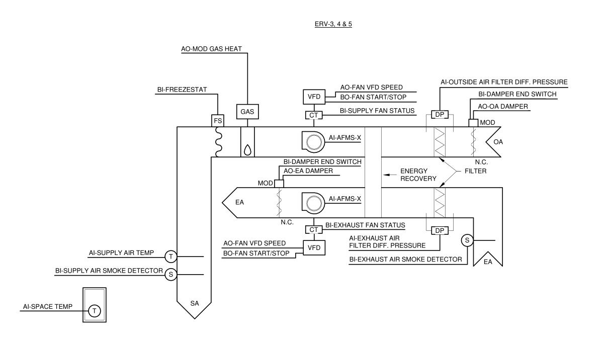
SEQUENCE OF OPERATIONS: VARIABLE VOLUME MAKEUP AIR UNIT CONTROL (ERV-3, 4 & 5):
