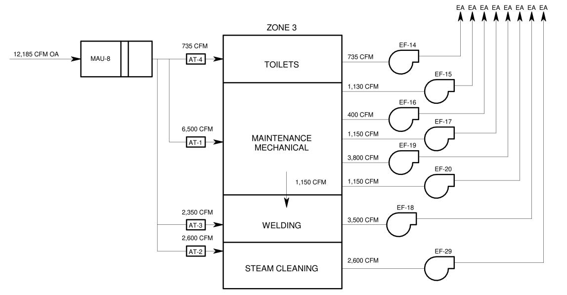
4 MAINTENANCE MECHANICAL AIRFLOW DIAGRAM
